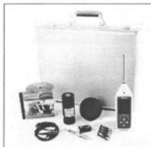
Слика бр. 1: Инструмент за мерење на бучава Cirrus CR: 171B
